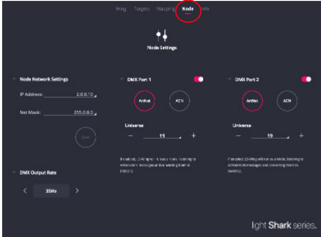
**Port DMX:** LS-Wing integriert ein Node mit 2 Universen DMX-512, die unabhängig voneinander frei konfiguriert werden können. Für jeden DMX-Port kann ein anderes Protokoll oder Universum konfiguriert werden.
